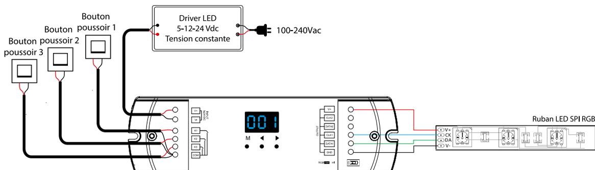
Avec plusieurs rubans SPI (charge du ruban LED supérieure à 8 A)
