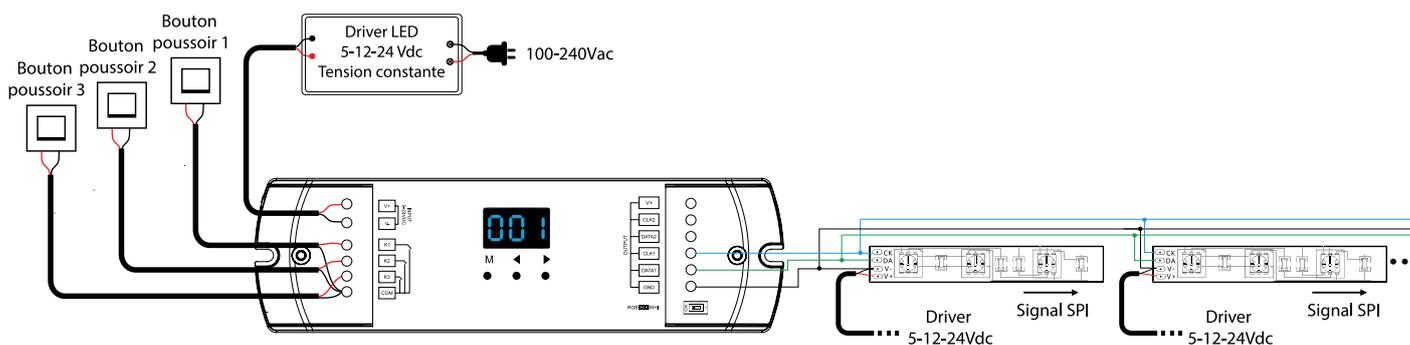
⚠ Lorsque la charge du ruban dépasse 8 , le ruban LED doit être alimenté par une autre alimentation (le ruban LED et l'alimentation doivent partager la même mise à la terre), et seuls les fils DATA/clk et GND sont connectés entre le contrôleur et le ruban LED.
