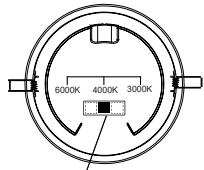
Changement de la température de couleur grâce au DIP switch
