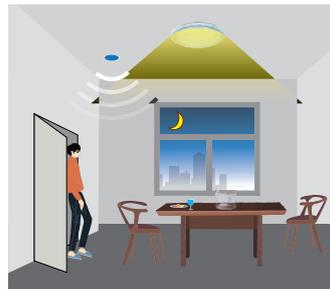
Avec du mouvement et un niveau de lux ambiant insuffisant, la lumière est déclenchée par le détecteur.
