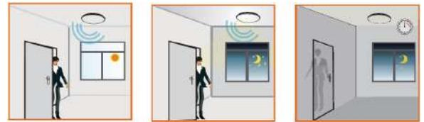
Fonctionne lorsque la luminosité ambiante est inférieure à 50 lux.
