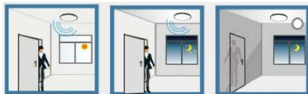
Fonctionne lorsque la luminosité ambiante est inférieure à 50 lux.
