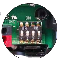
DIP switches Réglage du courant
