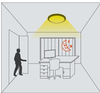
Avec du mouvement et un niveau de lux ambiant insuffisant, la lumière est déclenchée par le détecteur.
