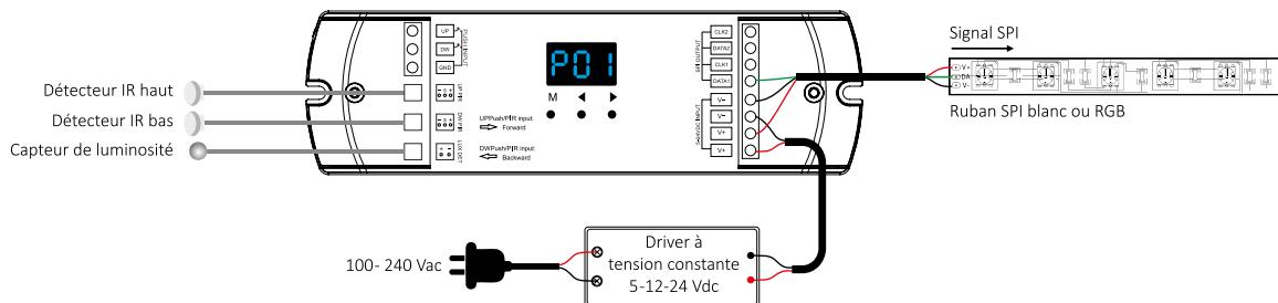
Pour une lumière d'escalier, connexion au capteur infrarouge et contrôle par marche
