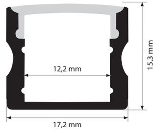
Convient aux rubans d'une largeur maximale de 12 mm.
