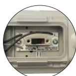
DIP switch pour le réglage de la température de couleur
